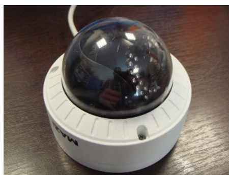
dopuszczalne pochylenie – wszystkie diody są ponad obudowę
