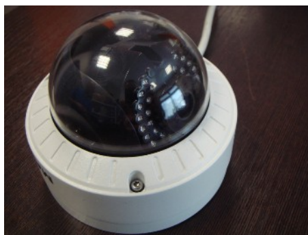
zbyt duże pochylenie – część diod świeci w obudowę
