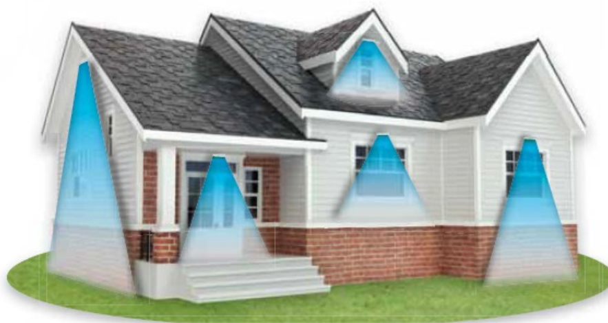
zastosowanie czujek kurtynowych nadokiennych
