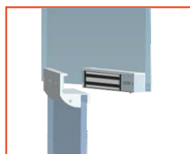
Montaż z uchwytem typu "GZ"
