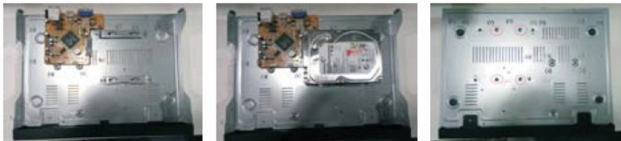
Montaż dysku w rejestratorach IMVR-06S, IMVR-09S
