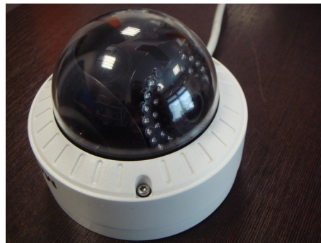
zbyt duże pochylenie – część diod świeci w obudowę
