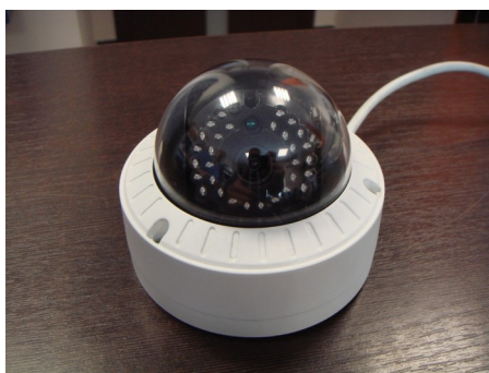
dopuszczalne pochylenie – wszystkie diody są ponad obudowę
