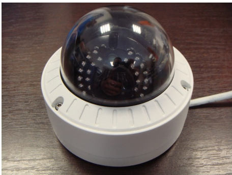
zbyt duże pochylenie – część diod świeci w obudowę
