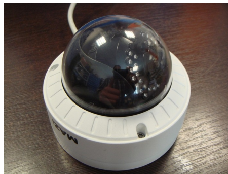
dopuszczalne pochylenie – wszystkie diody są ponad obudowę
