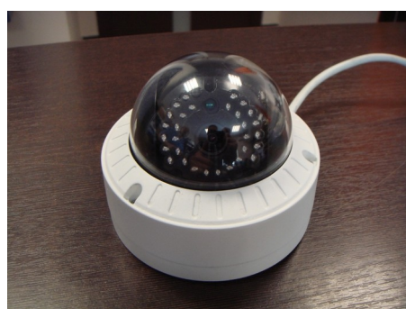
dopuszczalne pochylenie – wszystkie diody są ponad obudowę
