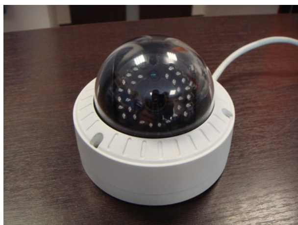
dopuszczalne pochylenie – wszystkie diody są ponad obudowę
