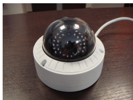
dopuszczalne pochylenie – wszystkie diody są ponad obudowę
