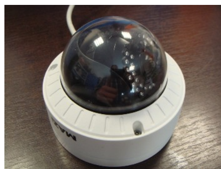
dopuszczalne pochylenie – wszystkie diody są ponad obudowę
