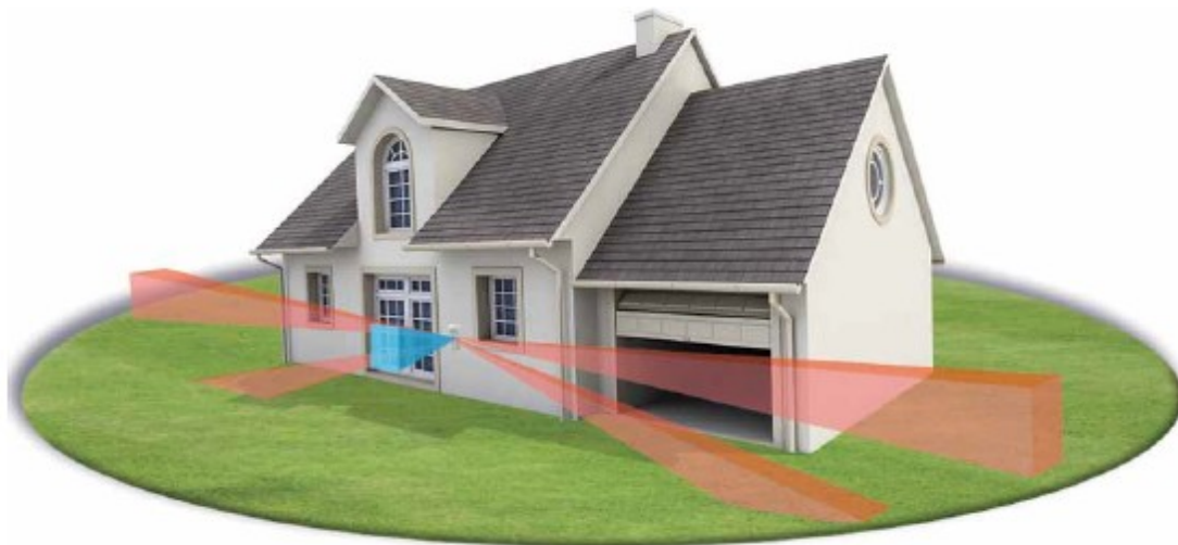
zastosowanie czujek kurtynowych ściennych
