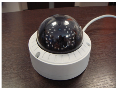
dopuszczalne pochylenie – wszystkie diody są ponad obudowę
