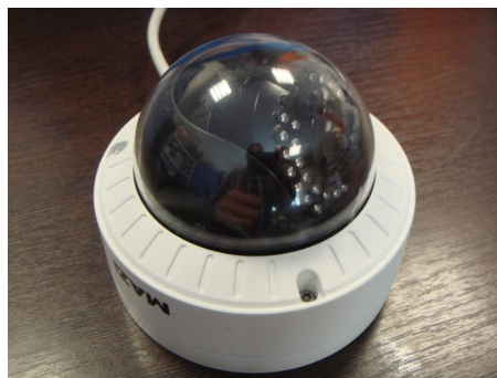
dopuszczalne pochylenie – wszystkie diody są ponad obudowę
