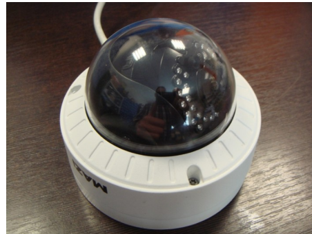
dopuszczalne pochylenie – wszystkie diody są ponad obudowę
