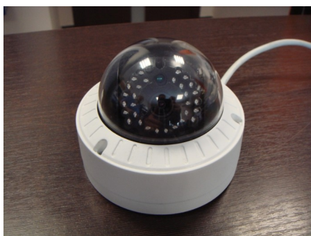
dopuszczalne pochylenie – wszystkie diody są ponad obudowę
