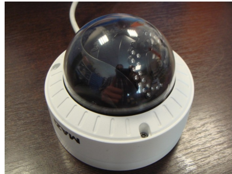
dopuszczalne pochylenie – wszystkie diody są ponad obudowę
