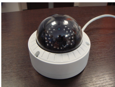
dopuszczalne pochylenie – wszystkie diody są ponad obudowę
